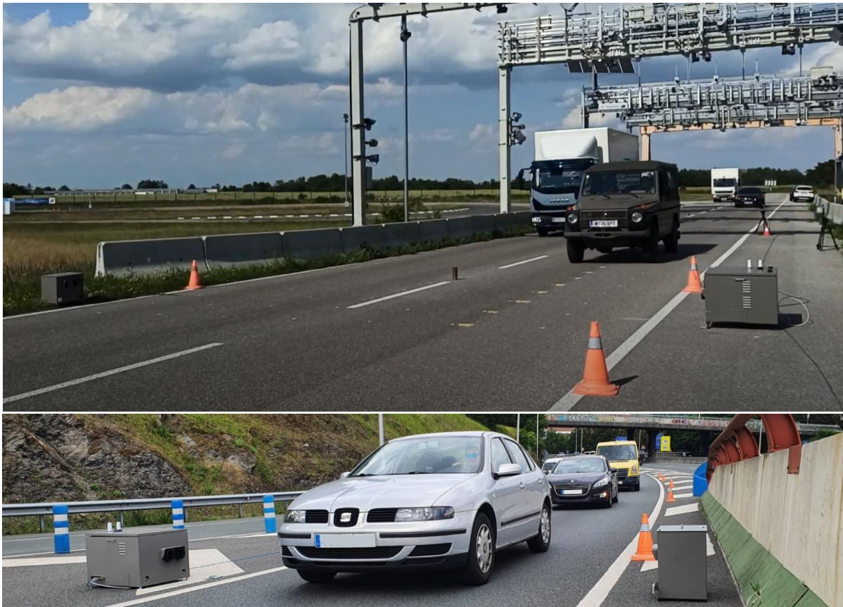
Abbildung 3: Die Testung des Messsystems bestehend aus der Messstation und des Reflektors auf der -Teststrecke der KTC in Teesdorf mit unterschiedlichen Fahrzeugklassen (oben); das Emissionsmesssystem im Realtest in Spanien (unten). [1], [2], [3]
